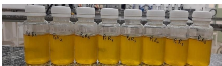
Figura 8 – Teste positivo para coliformes totais no ponto de coleta 1.
