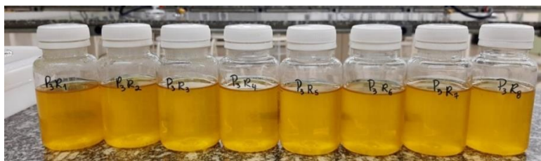
Figura 10 – Teste positivo para coliformes totais no ponto de coleta 3.
