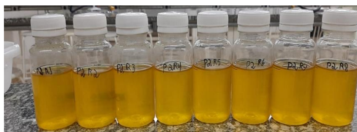
Figura 9 – Teste positivo para coliformes totais no ponto de coleta 2.
